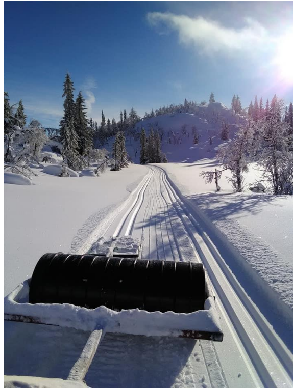
Rullende kompaktor som Håvard har bygget
